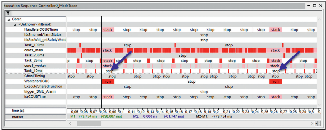
Bild 1: Im Execution Sequence Chart erkennt man schnell die Unregelmäßigkeiten in der Task-Ausführung des Schedulers. Auch die Ursache dafür ist leicht zu identifizieren. © PLS
